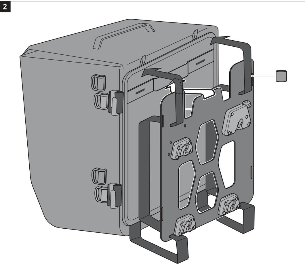
Verschleifen Sie die Adapterplatte zunächst locker mit den vertikalen Gurten an der SysBag.
