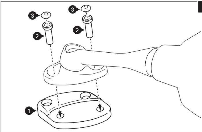
**2** Verschrauben Sie die Rückspiegel auf den Kontur-Distanzstücken (1), wie in der Zeichnung gezeigt. Ziehen Sie die Schrauben wie in der Stückliste vorgegeben an.
