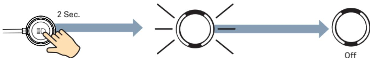
**DE** Halte den Schalter für das Fernlicht 2 Sekunden lang gedrückt, um den Scheinwerfer auszuschalten. Schaltet man den Scheinwerfer im Tagfahrlichtmodus aus, erlischt das Licht sofort.
